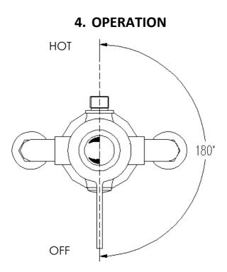
NOTE: THIS DIAGRAM DEPICTS A LEVER TYPE HANDLE BUT THE OPERATING PRINCIPLE IS THE SAME REGARDLESS OF THE HANDLE. THE ABOVE IS THE RECOMMENDED LEVER ORIENTATION.
