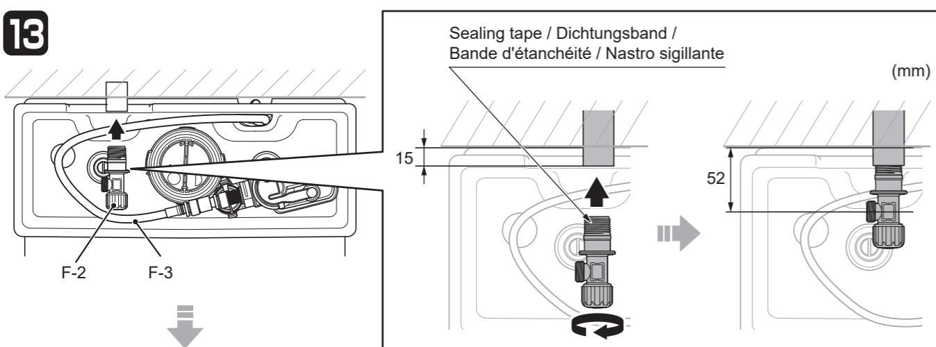
When installing the shutoff valve inside the tank / Bei Installation des Absperrventils im Tank / Si vous installez le robinet d'arrêt dans le réservoir / Quando si installa la valvola di arresto all'interno del serbatoio
