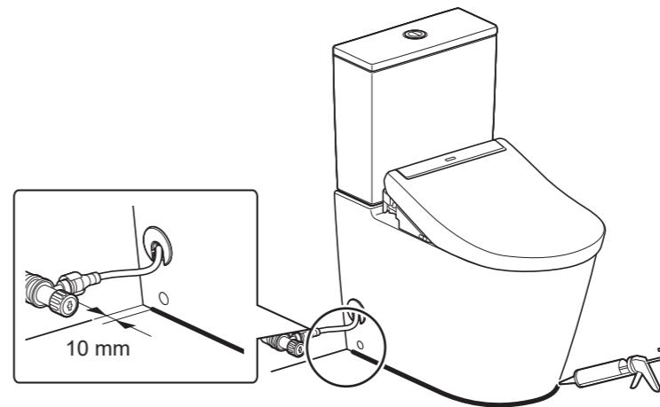
When installing the shut-off valve outside the tank / Bei Installation des Absperventils außerhalb des Tanks / Si vous installez le robinet d'arrêt hors du réservoir / Quando si installa la valvola di arresto all'esterno del serbatoio
