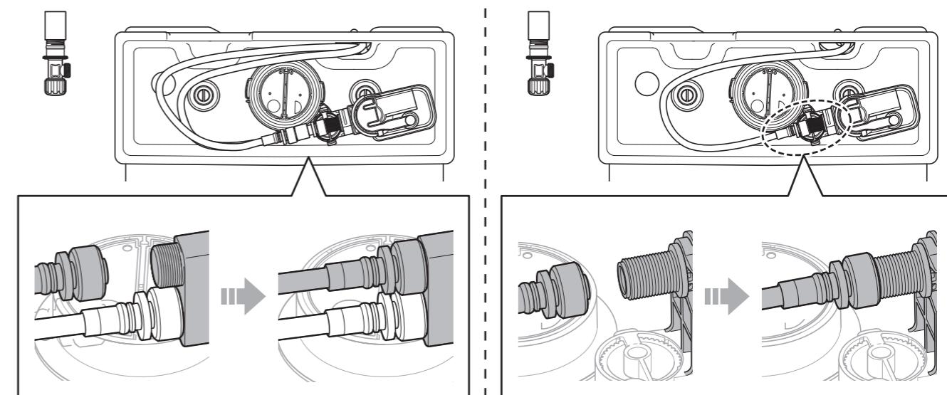
When installing the shutoff valve outside the tank / Bei Installation des Absturzventils außerhalb des Tanks / Si vous installez le robinet d'arrêt hors du réservoir / Quando si installa la valvola di arresto all'esterno del serbatoio
