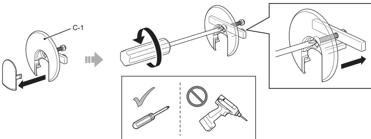
When installing the shutoff valve outside the tank / Bei Installation des Absperventils außerhalb des Tanks / Si vous installez le robinet d'arrêt hors du réservoir / Quando si installa la valvola di arresto all'esterno del serbatoio
