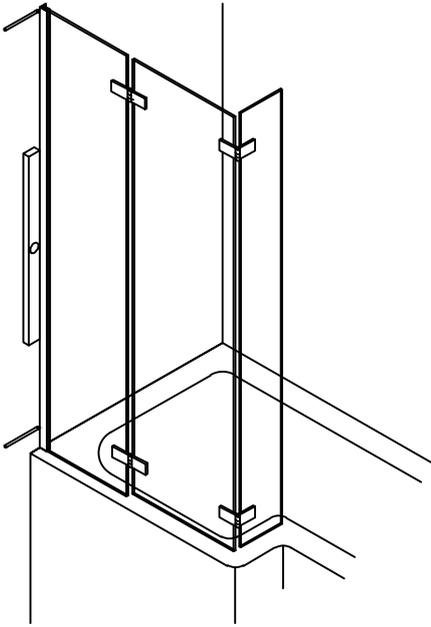
**2. PUT THE WALL POST ONTO THE FIXED PANEL, WITH THE HELP OF ANOTHER PERSON PLACE IN POSITION ON THE BATH. USING A SPIRIT LEVEL MARK THE POSITION OF THE WALL POST ON THE WALL WHERE IT WILL BE FIXED.**
