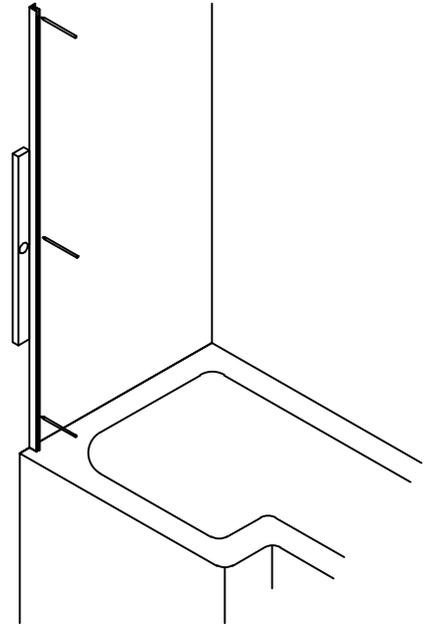
**3. REMOVE THE SCREEN AND WALL POST FROM THE BATH, TAKE THE WALL POST AND PUT BACK INTO POSITION, USING A SPIRIT LEVEL TO ENSURE THAT THE POST IS PLUMB MARK THE POSITION OF THE 3 FIXING HOLES.**
