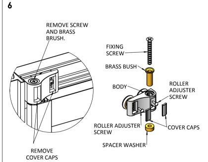
CHECK THE DOOR RUNS SMOOTH AND THE ROLLER DOESN'T CATCH ON THE TRAY AT THE BOTTOM.
