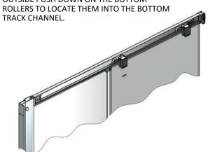
WHEN BOTH DOORS ARE FITTED TURN THE ADJUSTER SCREW ON THE TOP ROLLERS TO LEVEL THE DOORS AND MAKE THEM TRUE TO EACH OTHER.
