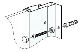
ONCE SIDE PANEL IS SQUARE AND TRUE, MARK THE POSITION OF THE SIDE PANEL'S WALL PROFILE ON THE WALL THROUGH THE WALL PROFILE FIXING HOLES USING A PENCIL.
