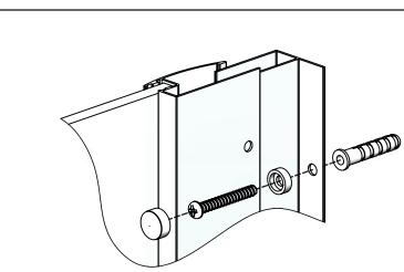
ONCE SIDE PANEL IS SQUARE AND TRUE, MARK THE POSITION OF THE SIDE PANEL'S WALL PROFILE ON THE WALL THROUGH THE WALL PROFILE FIXING HOLES USING A PENCIL.
