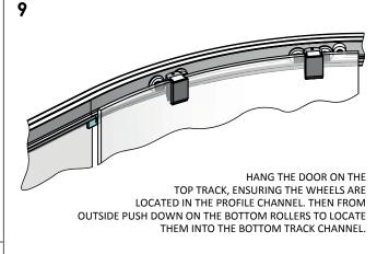
WHEN BOTH DOORS ARE FITTED TURN THE ADJUSTER SCREW ON THE TOP ROLLERS TO LEVEL THE DOORS AND MAKE THEM TRUE.
