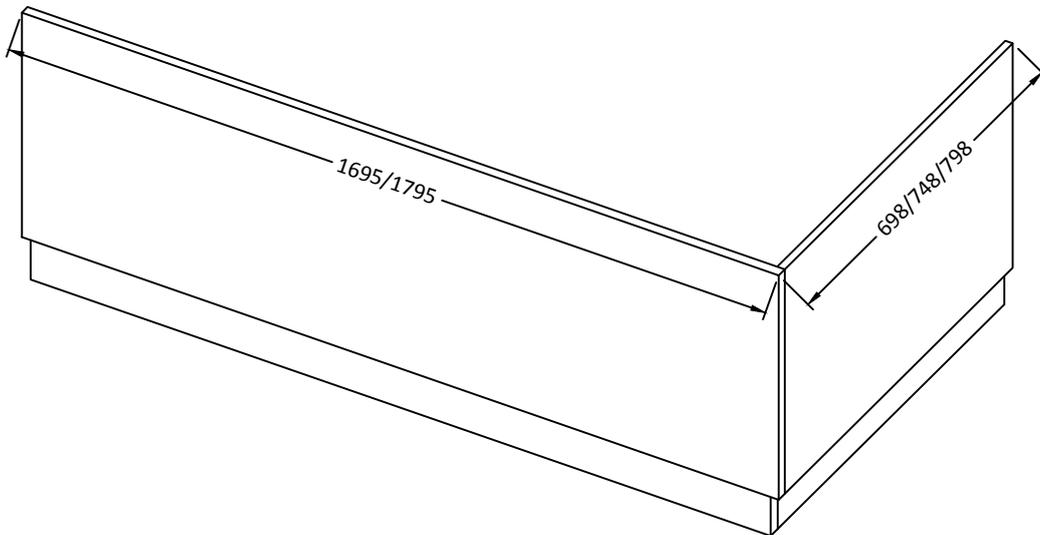
1. MEASURE FROM THE UNDERSIDE OF THE BATH RIM TO THE FLOOR TO ESTABLISH THE HEIGHT OF THE BATH PANEL REQUIRED.
