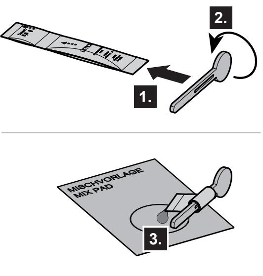
**DE** Den i.Stick mit dem Tubenschlüssel aufrollen bis die Trennnahrt aufplatzt. Dann den Klebstoff auf die Mischvorlage auftragen.
