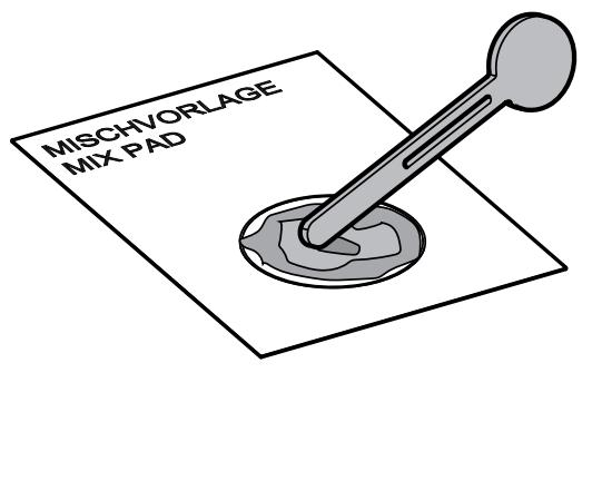
**DE** Im Anschluss das Klebstoffgemisch mit dem Tubenschlüssel auf der Mischvorlage vermischen bis eine hellgraue Klebemasse entsteht.
