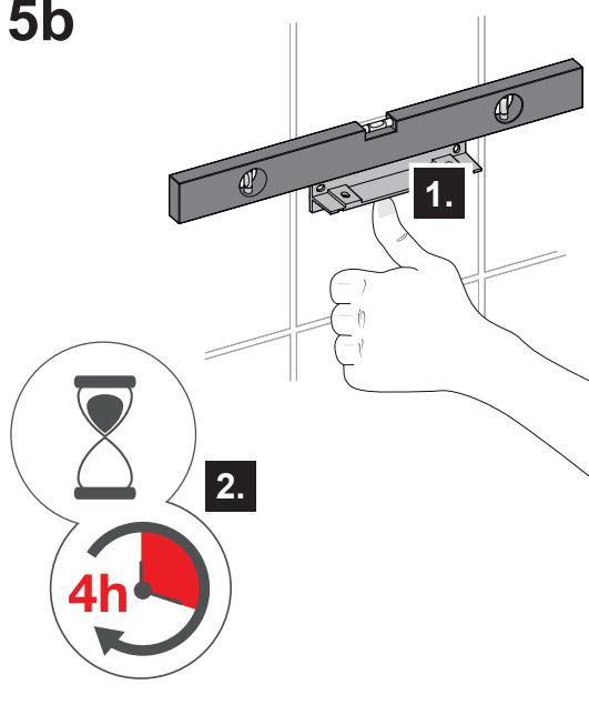
**DE** Montageplatte fest andrücken und 4 Stunden aushärten lassen. Anschließend Klebereste vorsichtig entfernen und Accessoire montieren.
