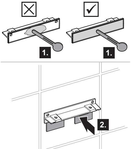
**DE** Den Klebstoffs mit dem beiliegenden Tubenschlüssel auf die Montageplatte auftragen. Ggf. Karton zur Fixierung nutzen.
