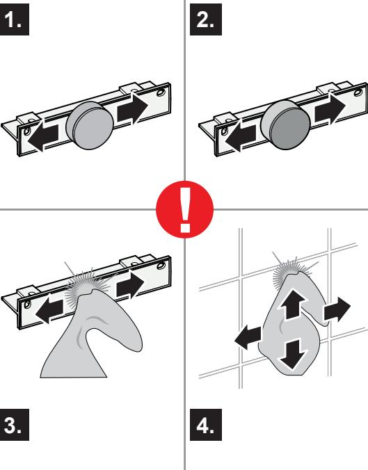
**DE** Klebefläche der Montageplatte mit dem Schleifvlies anschleifen und anschließend Montageplatte und Fliesenfläche gründlich mit dem Reinigungstuch i.CLEANER reinigen.
