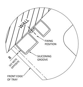
ENSURE THAT THE SILICONING GROOVE ON THE PROFILE IS TO THE OUTSIDE OF THE ENCLOSURE.
