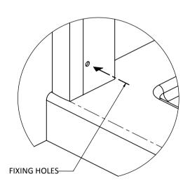
ENSURE THAT THE SILICONING GROOVE ON THE PROFILE IS TO THE INSIDE OF THE ENCLOSURE AND AGAINST THE WALL.
