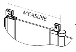
MEASURE FROM THE INSIDE FACE OF THE WALL 'U' BRACKET TO THE FRONT FACE OF THE SCREEN 'U' BRACKET AND CUT THE TOP BAR 2mm SHORTER
