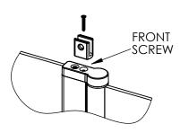
FIT THE 'U' BRACKET TO THE WALL
