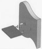
DRILL THE HOLES IN THE WALL TO TAKE THE WALL PLUGS, RECESS/CHASE IN THE AREA AROUND THE BRACKET SO IT IS LEVEL WITH THE WALL SURFACE. FOR STUD WALLS IT IS ESSENTIAL THAT THE SHELF IS SUPPORTED BY A FULLY BATTENED STUD PATITION.
