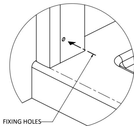
ENSURE THAT THE SILICONING GROOVE ON THE PROFILE IS TO THE INSIDE OF THE ENCLOSURE AND AGAINST THE WALL.
