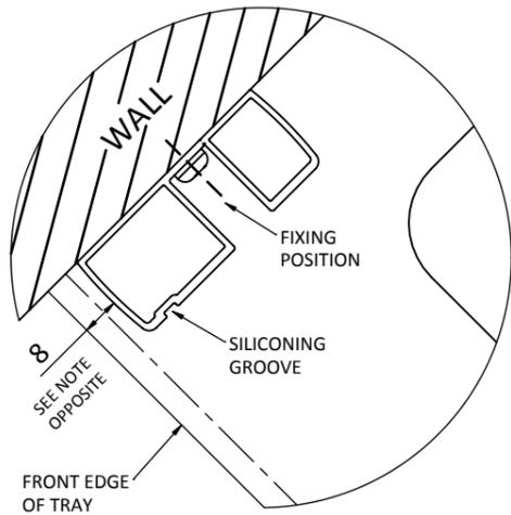
ENSURE THAT THE SILICONING GROOVE ON THE PROFILE IS TO THE OUTSIDE OF THE ENCLOSURE.
