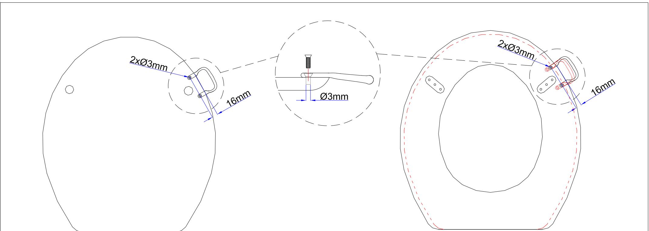
1. Une partie de la poignée est d'une surface plate. Placez la surface plate de la poignée contre le couvercle de l'abattant afin de déterminer la position finale de la poignée (cf diagramme ci-dessus), marquez l'emplacement des trous de fixation au crayon. Notez que le butoir se trouve au milieu des deux trous de fixation.
