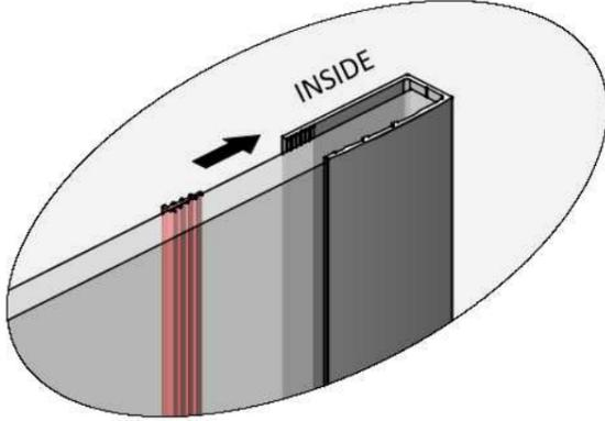
INSERT PUSH IN 'V' SEAL AS SHOWN.
