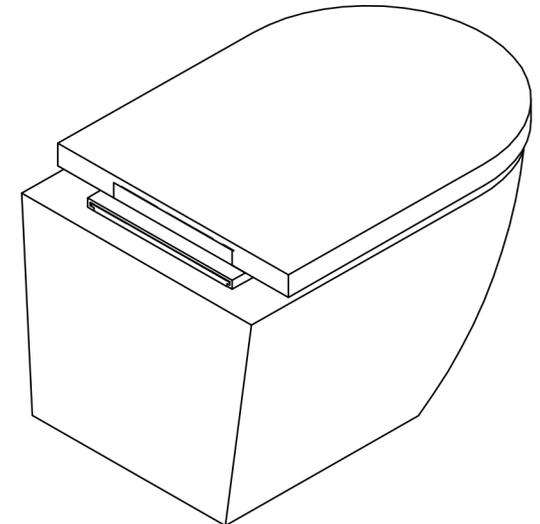
**SLIDE THE SEAT AND HINGE PLATE BACK INTO POSITION AND FIX USING THE RETAINING SCREWS.**
