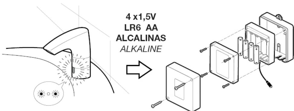
**ES** El grifo avisa de la necesidad de reemplazar las pilas mediante destellos intermitentes del visor inferior cada vez que se utilice el grifo. Ud. dispondrá de varios días para realizar el cambio de pilas.
