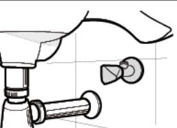
**ES** Montar el conjunto casquillo-filtro-antirretorno (modelos mezcladores) o únicamente el filtro (modelos sin mezclador).
