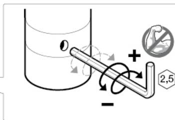
**ES** Se realiza con la ayuda de una llave Allen N° 2,5 por la parte posterior del grifo, después de alcanzar el caudal máximo de agua.
