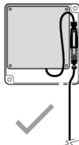
**ES** **ATENCIÓN:** Conectar la alimentación, recoger el cable dentro de la caja de sujeción, como se indica en la figura y cerrar la caja atornillando los tornillos.
