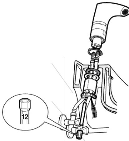
**ES** Montar grifo en el lavabo mediante el conjunto de sujeción.
